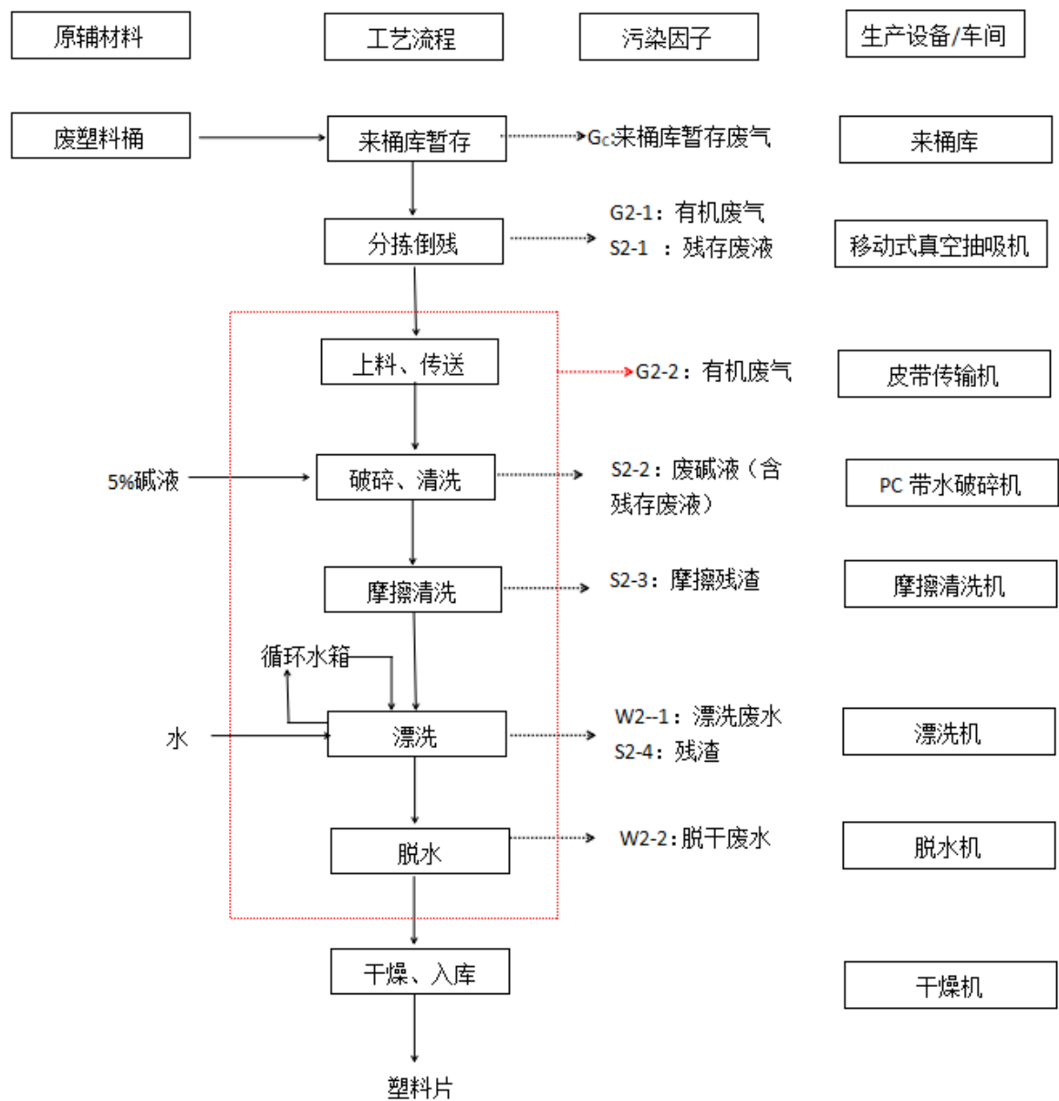
图 3.1.3-3 废塑料桶破碎清洗生产线工艺流程图
