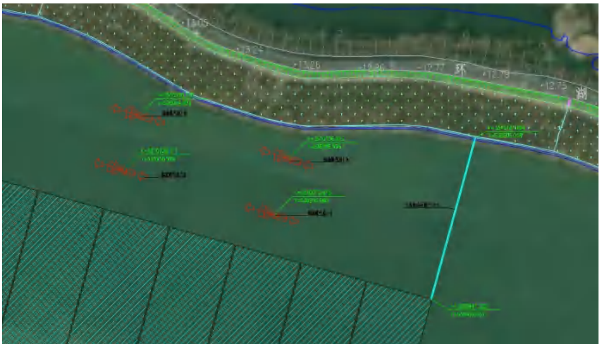
图 3.3.2-6 推流曝气机布置图
