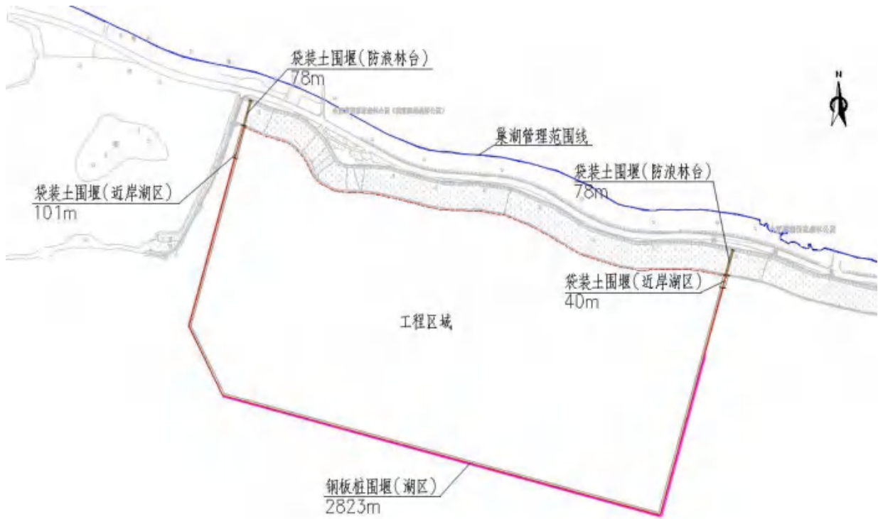
图 3.3.1-12 围堰平面示意图
