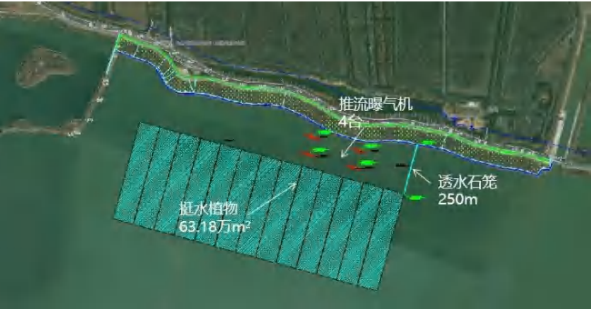
图 3.3.2-1 湖滨带生态恢复试点工程平面布置图
