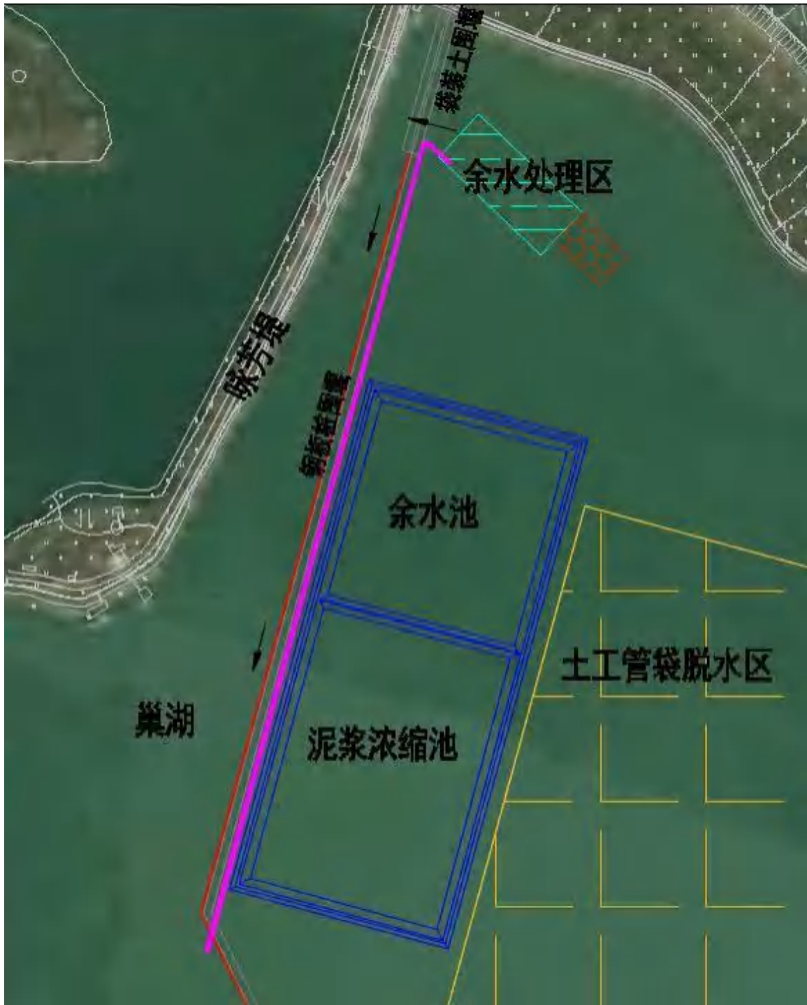
图 3.3.1-34 余水排放管道路由方案一示意图
