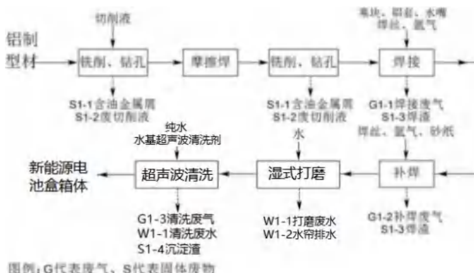
图 3.5-2 变动后新能源电池盒箱体生产工艺流程图
