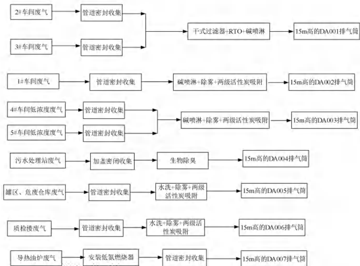
图 6.1.1-1 废气收集处理系统流程框图
