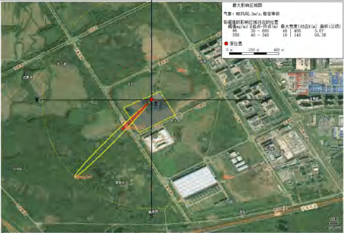
图 5.8-3 最不利气象条件下丙烯储罐泄漏引发的火灾伴生/次生事故预测结果
