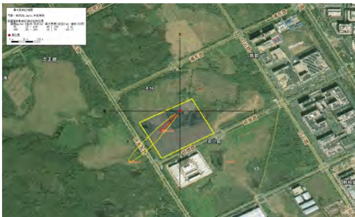
图 5.8-4 最常见气象条件下丙烯储罐泄漏引发的火灾伴生/次生事故预测结果
