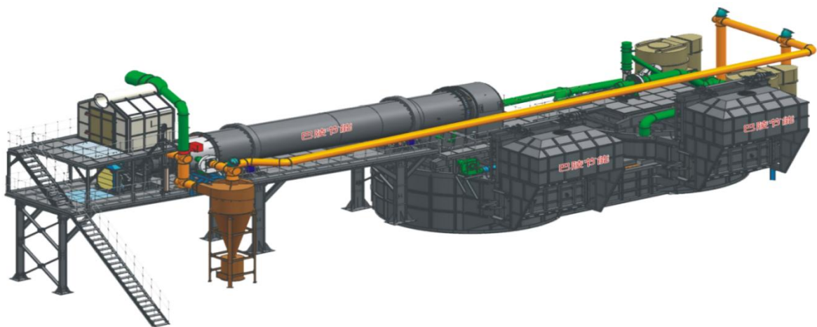
图 3.6-4 本项目预热回转窑和蓄热熔炼炉三维工艺流程
