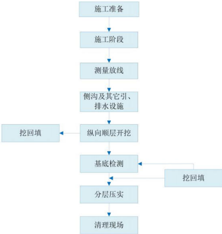
图 4-1 路基挖方工艺流程图
