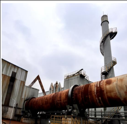
窑头窑尾废气排气筒标识牌+采样平台（DA090）
