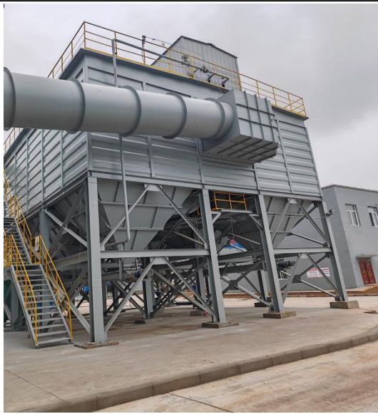
含尘废气布袋除尘器及其排气筒（DA089）
