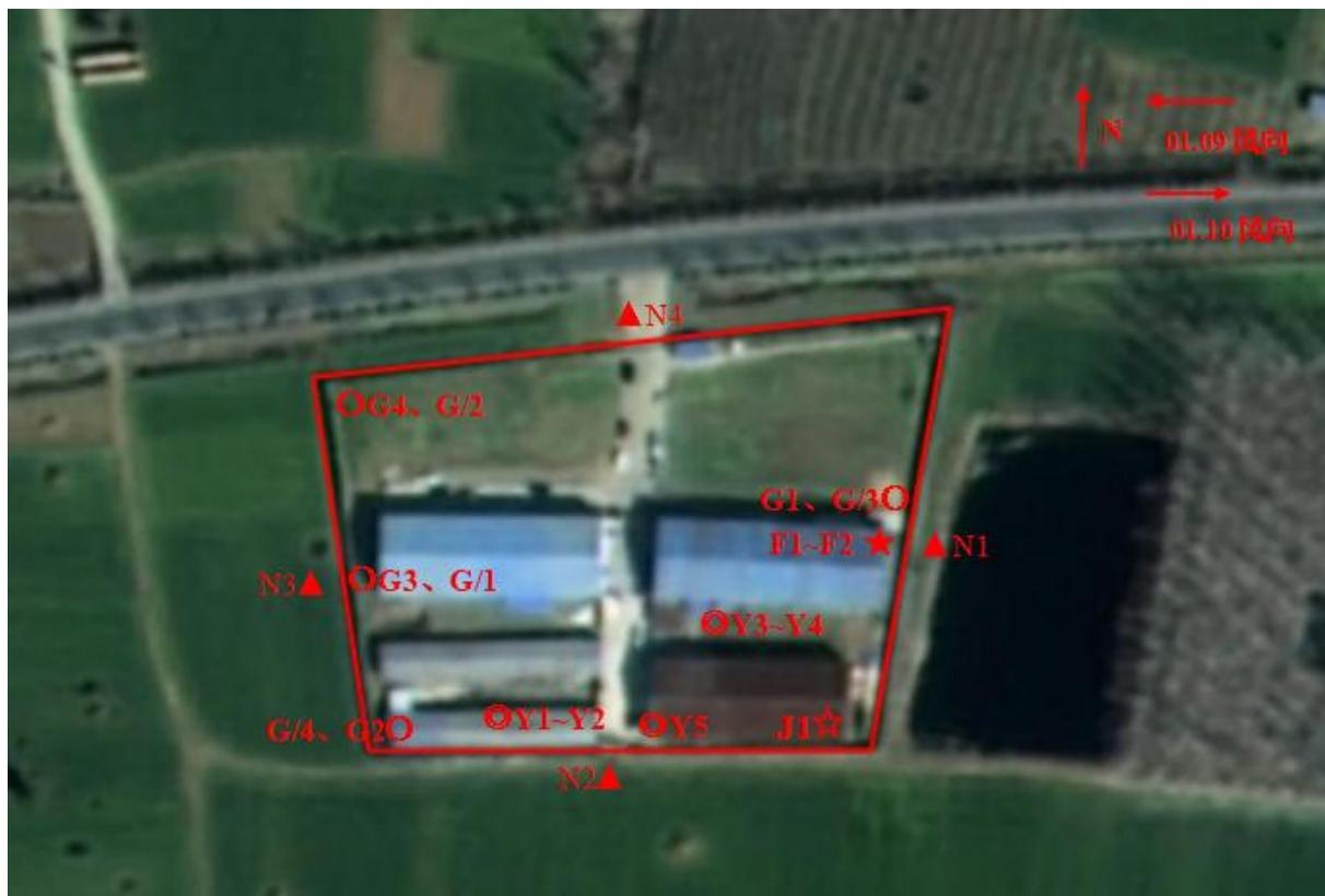
图 7.3-1 检测点位示意图 (★废水检测点位; ☆地下水检测点位; ▲厂界噪声检测点位; ○无组织废气检测点位; ◎有组织废气检测点位)
