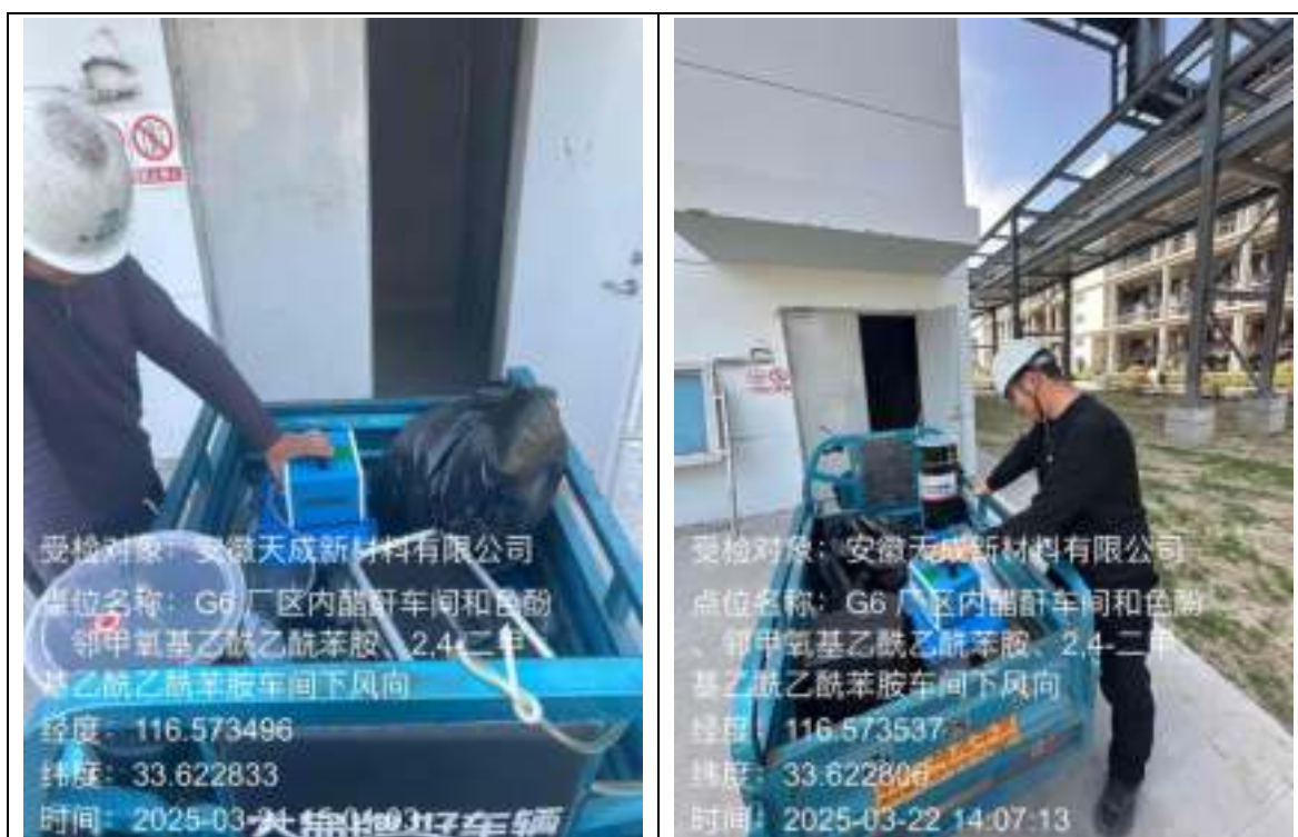
车间外无组织废气检测
