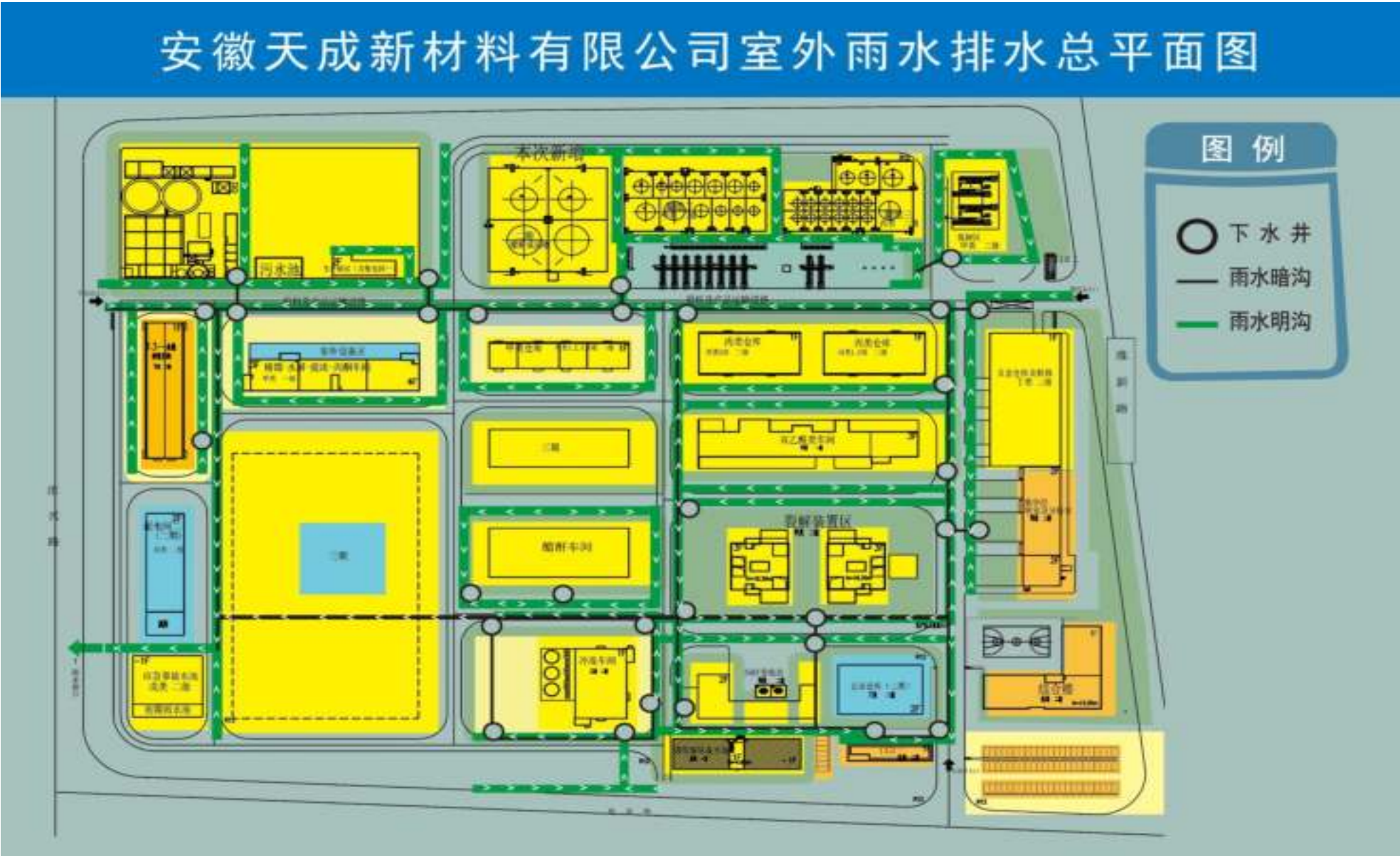
附图 4 厂区雨水管网图
