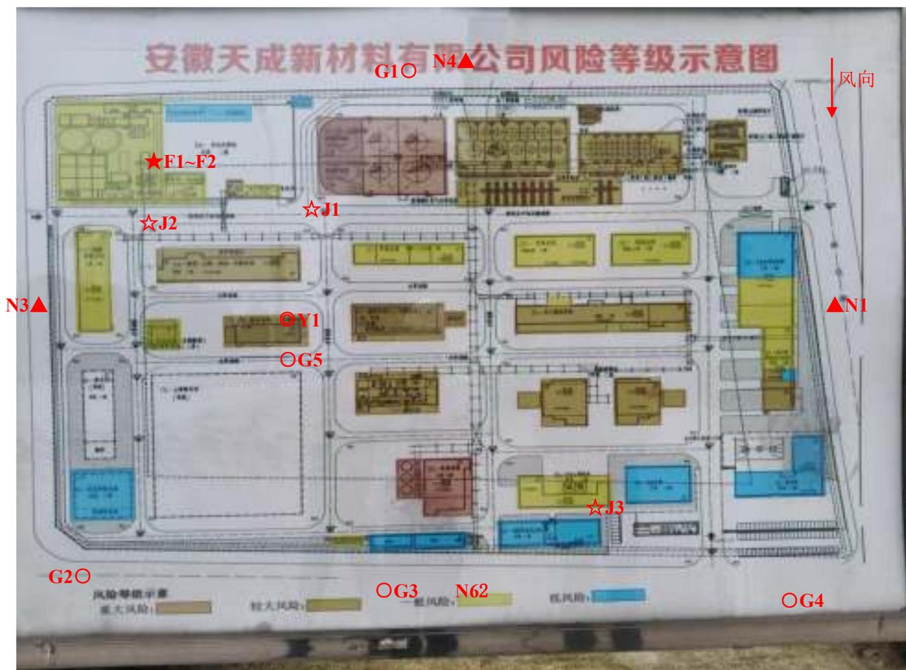
图 7.3-1 检测点位示意图 (★废水检测点位; ☆地下水检测点位; ▲厂界噪声检测点位; ○无组织废气检测点位; ◎有组织废气检测点位)
