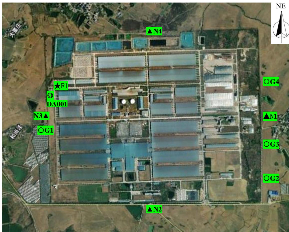
(★废水检测点位、▲厂界噪声检测点位、◎有组织废气检测点位、○无组织废气检测点位；
