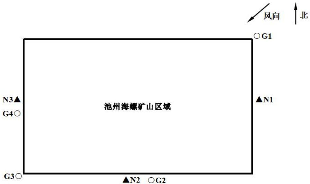
图 7.2-2 矿山厂区检测点位示意图 (▲厂界噪声检测点位; ○无组织废气检测点位)
