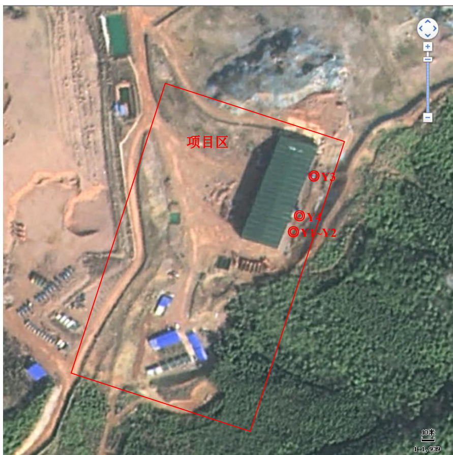
图 6.5-1 破碎站有组织废气检测布点示意图 (◎有组织废气监测点位; ○无组织废气监测点位; ▲厂界噪声监测点位)
