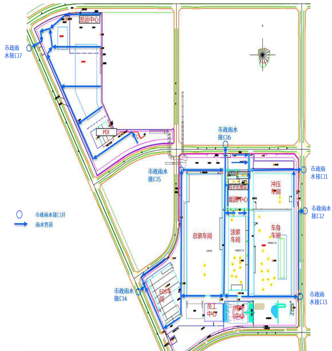
附图 3 厂区雨水管网图
