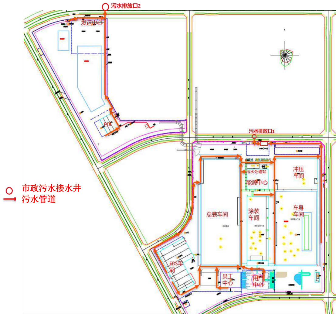
附图 4 厂区污水管网图
